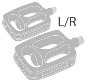
Drehen Sie die Achse des Pedals von Hand in das entsprechende Schraubenloch in der Kurbel. Ziehen Sie das Pedal mit dem 15er Maulschlüssel fest. Das linke Pedal wird LINKSHERUM in die linke Kurbel geschraubt, das rechte Pedal wird RECHTSHERUM in die rechte Kurbel geschraubt.
